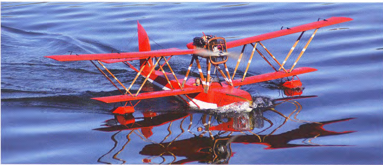
Giuseppe Biscotti flog diese schöne Macchi M19, die bei einer Spannweite von 2 m nur 4 kg wiegt und durch einen OS-90 Viertakter angetrieben wird.
